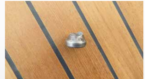
Ist das Wantenterminal erst einmal gebrochen ist es meist zu spät
