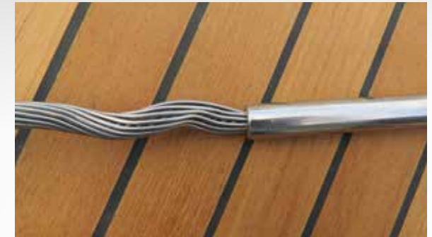
Verbogene Wanten verlieren stark an Bruchlast und können früher oder später zum Mastbruch führen
